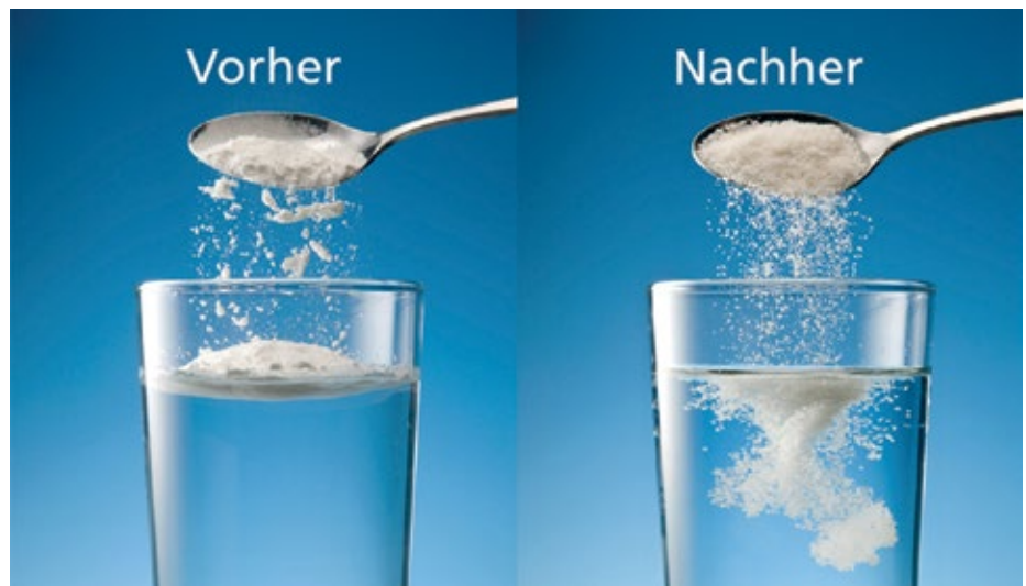
■ Abb. 2: Wasser benetzt Pulver mit einer Partikelgröße von unter 100 µm nur schlecht (links). Für ein sicheres Handling und optimale Verarbeitungseigenschaften müssen sie daher instantisiert werden. Dadurch steigt die Benetzbarkeit des Pulvers (rechts).
