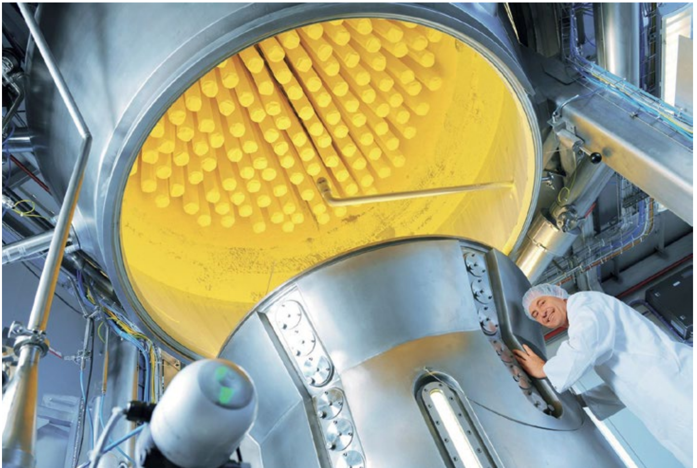
■ Abb. 1: Ein Blick in die Wirbelschichtanlage bei Sternmaid.
