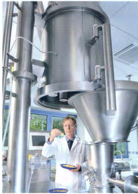
In der Wirbelschichtanlage können Unternehmen Granulationen, Agglomerationen, Coatings und Mikroverkapselungen durchführen
