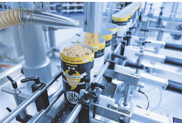
Das anschließende Abfüllen der Purya-Proteinpulver in die charakteristischen bunten Dosen erfolgt vollautomatisch auf einer 2-Kopfabfüllanlage
